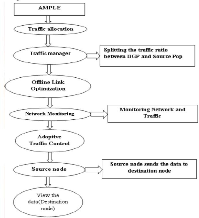
Fig.3.1 AMPLE structure
